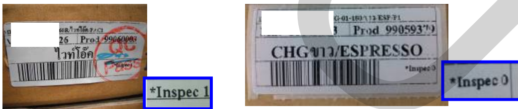
ภาพที่ 4.12 แสดงถึงการทำสัญลักษณ์ในการตรวจสอบชิ้นงานที่ต่อประกอบ และชิ้นงานซ่อม
