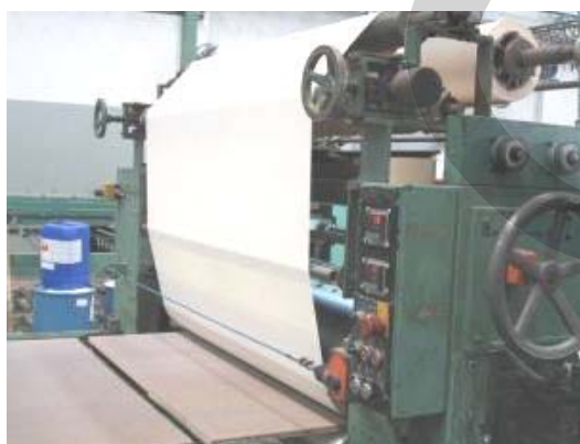
ภาพที่ 3.6 ตัวอย่างการปิดผิวฟอรับบนพื้นผิวไม้ด้วยเครื่องปิดผิว
