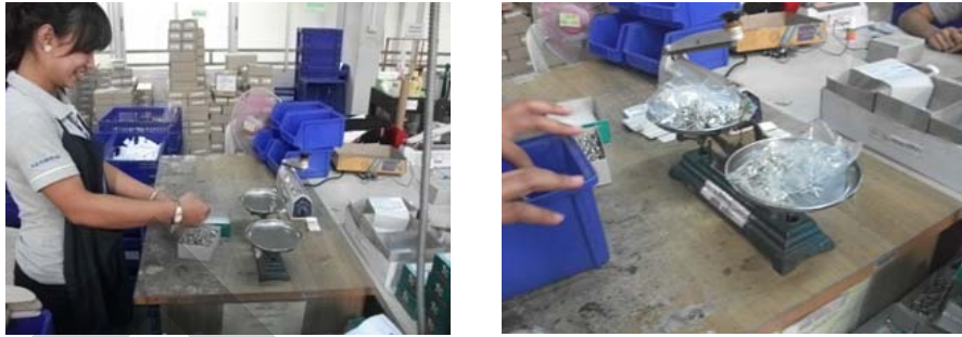
ภาพที่ 4.30 แสดงการนำเครื่องชั่งมาช่วยในการควบคุมปริมาณการบรรจุสุกร
