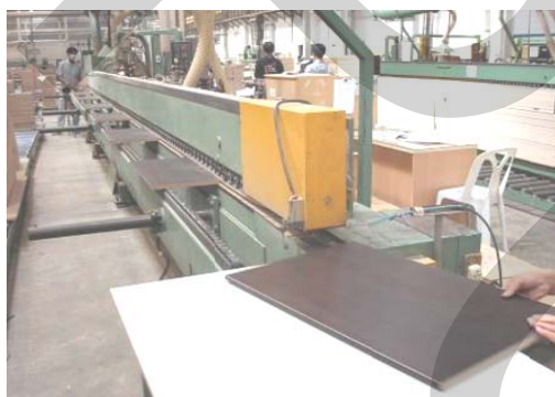
ภาพที่ 3.9 ตัวอย่างการตัดซอยห่อขอบชิ้นงานด้วยเครื่องห่อขอบ
