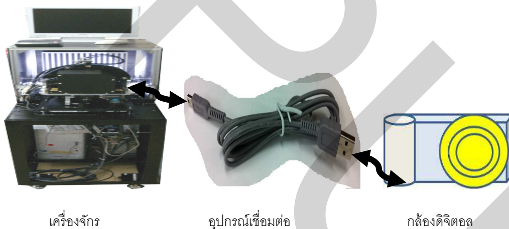
ภาพที่ 3.5 อุปกรณ์เชื่อมต่อกล้องดิจิทัลกับเครื่องทดสอบ
