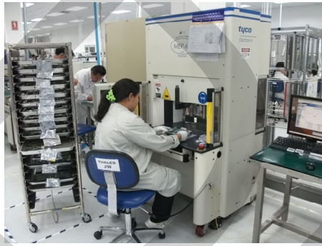
รูปที่ 3.10 แสดงการกดอุปกรณ์เชื่อมต่อประเภทอัดแน่น (Press fit connector)
