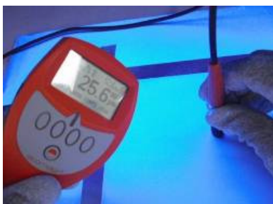
วัดความหนานบนอะลูมิเนียม
