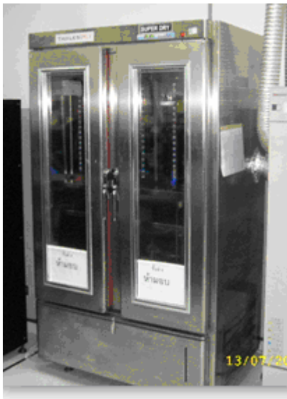
รูปที่ 3.9 แสดงการอบผลิตภัณฑ์ในตู้อบที่อุณหภูมิ 80 องศาเซลเซียส ที่เวลา 2 ชั่วโมง
