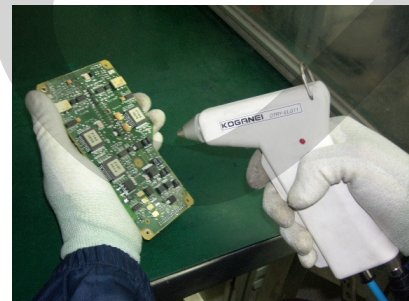
รูปที่ 3.4 แสดงเครื่องล้างด้วยน้ำยาเคมีชื่อ Vigon A200 และเป่าให้แห้งด้วย Ionizer air gun
