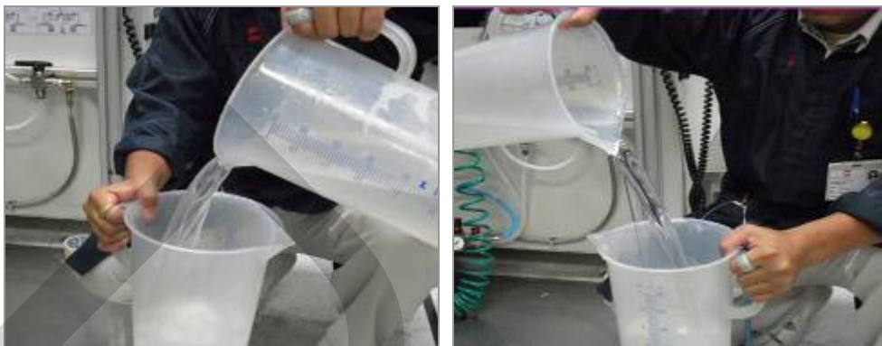
รูปที่ 4.22 แสดงวิธีการผสมน้ำยาเคลือบอะคริลิกโดยการเทสลับกันไปมา 20 ครั้ง
