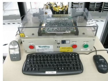
รูปที่ 3.11 แสดงการทดสอบการทำงานของผลิตภัณฑ์ (Functional Circuit Test)
