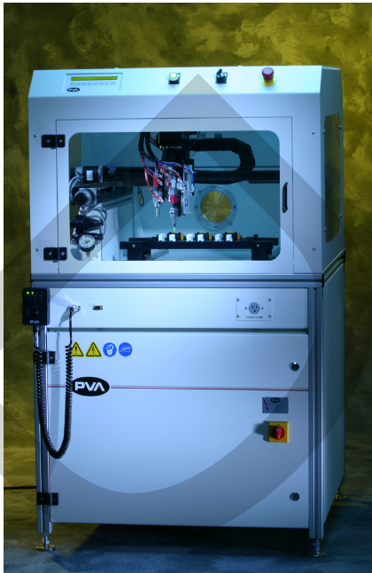
รูปที่ 3.6 แสดงลักษณะเครื่องเคลือบกึ่งอัตโนมัติ (Semi-Auto Coating Machine)
