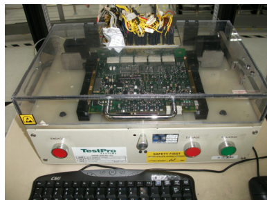
รูปที่ 3.11 แสดงการทดสอบการทำงานของผลิตภัณฑ์ (Functional Circuit Test)
