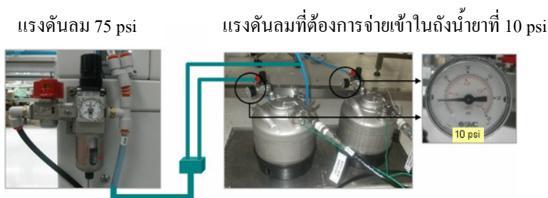
รูปที่ 4.10 แสดงระบบการจ่ายแรงดันลมหลักและแรงดันลมของถังน้ำยาเคลือบ
