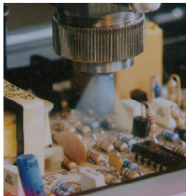
รูปที่ 3.7 แสดงลักษณะการเคลือบด้วยเครื่องเคลือบกึ่งอัตโนมัติ (Semi-Auto Coating Machine)
