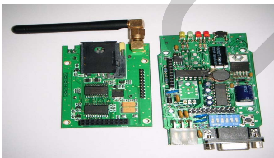
ภาพที่ 3.7 บอร์ดชุดจีเอสเอ็มโมดูลและชุดไมโครคอนโทรลเลอร์โมดูล
