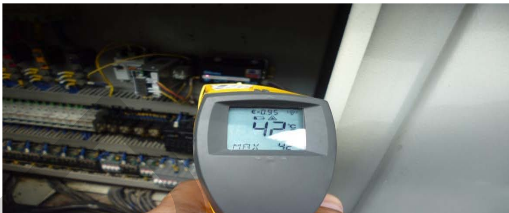
ภาพที่ 4.19 การวัดอุณหภูมิภายในตู้ควบคุม
