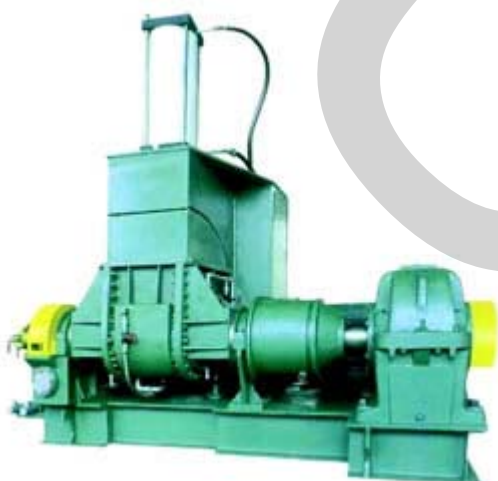
ภาพที่ 2.5 เครื่องบดผสมระบบปิด (Internal mixer)
