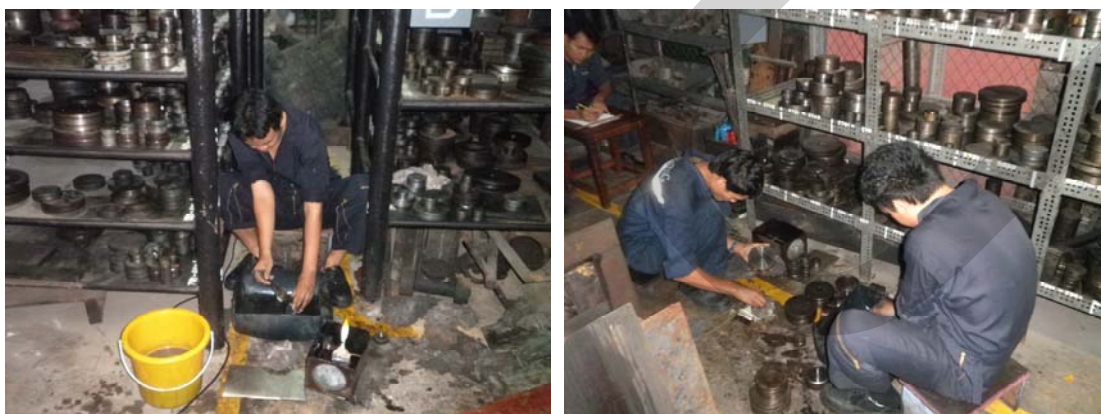
ภาพที่ 4.11 การทำความสะอาดแม่พิมพ์ก่อนและหลังการใช้งาน
