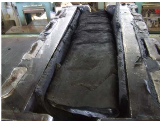
ภาพที่ 4.8 การเติมยางลงในแม่พิมพ์ (ก่อนการปรับปรุง)
