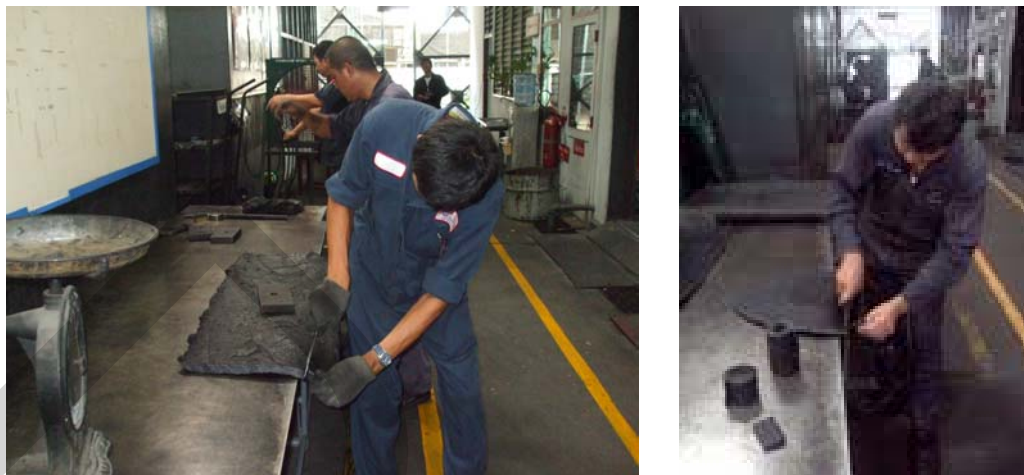
ภาพที่ 4.16 การเตรียมยางบนโต๊ะทำงานก่อนใส่แม่พิมพ์ (หลังการปรับปรุง)
