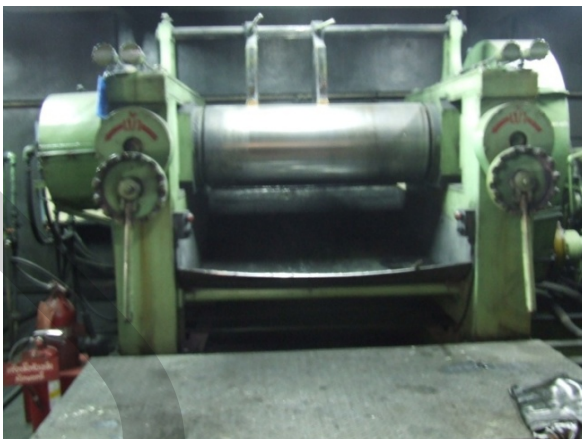
ภาพที่ 2.6 เครื่องบดผสมระบบเปิด (Two-roll mill)
