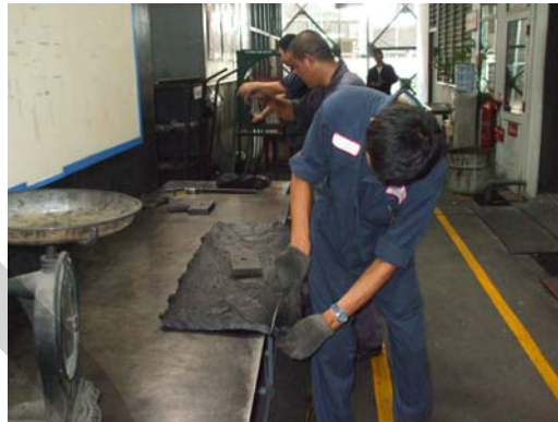
ภาพที่ ก-14 การปรับความหนาของแผ่นยางให้เหมาะสม เตรียมยางคอมพาวด์ (COMPOUND) ก่อนนำไปขึ้นรูป
