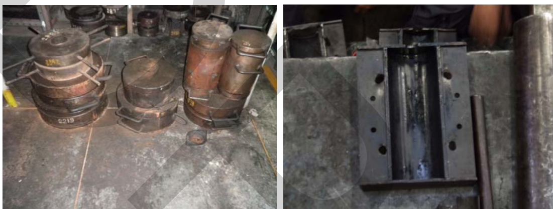
ภาพที่ 4.10 การเกิดสนิมบนแม่พิมพ์ (ก่อนการปรับปรุง)
