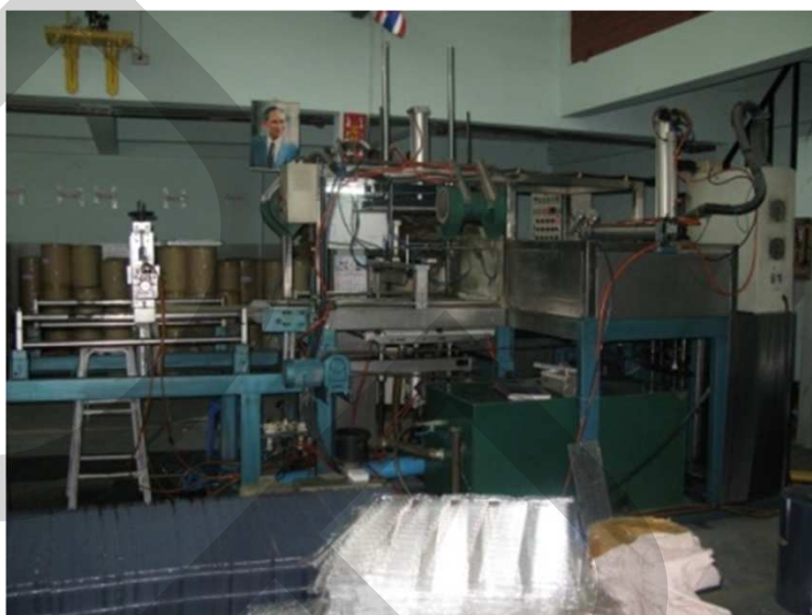
ภาพที่ 3.10 เครื่องขึ้นรูปพลาสติกด้วยสุญญากาศ ( Vacuum Machine )
