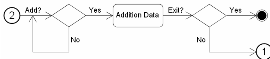
ภาพที่ 3.24 Activity Diagram การเพิ่มเติมข้อมูลเส้นทางรถโดยสารประจำทางผ่านเว็บเซอร์วิส
