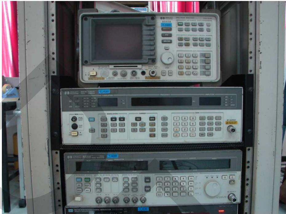
ภาพที่ 4.11 ภาพถ่าย Signal Generator HP8657B (ย่านความถี่ใช้งาน 0.1 MHz – 2060 MHz) และ Signal Generator HP83731A (ย่านความถี่ใช้งาน 1 GHz – 20 GHz)
