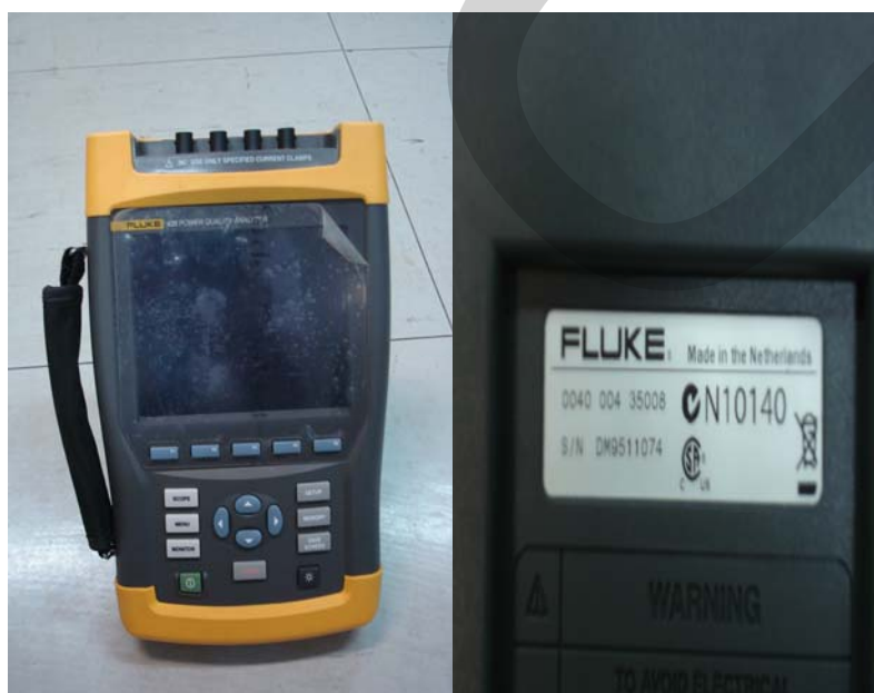
รูปที่ 3.6 เครื่องบันทึกพลังงานไฟฟ้า แรงดันไฟฟ้า (Power Analyzer)
