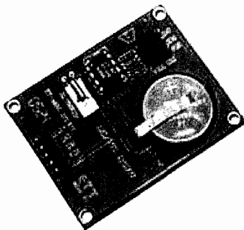
รูปที่ 3.10 โมดูลบอร์ดจัดการเวลาจริง (ET-MINI DS1307)
