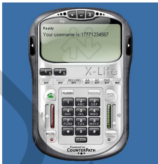
ภาพที่ 2.26 โปรแกรม X-Lite ที่ทำหน้าที่เป็น IP SoftPhone ที่รองรับมาตรฐาน SIP
