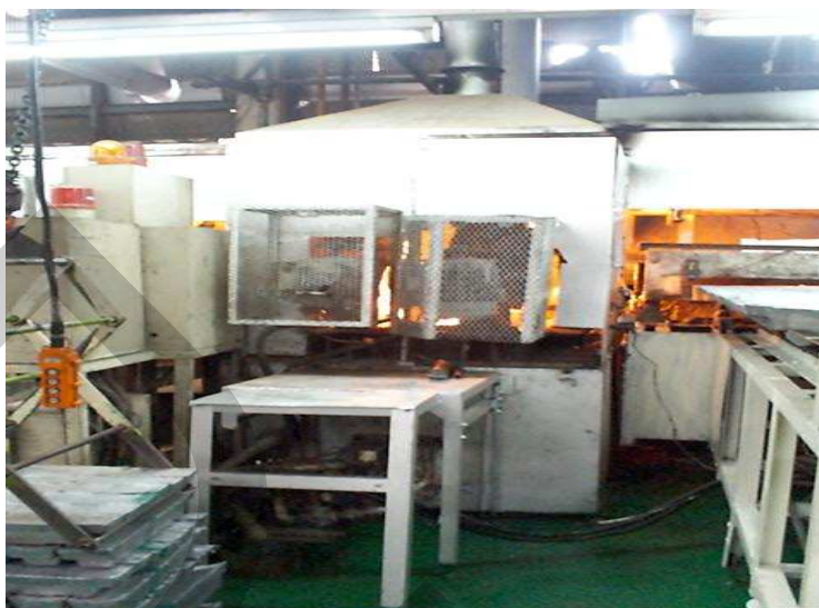
รูปที่ 3.2 เตาหลอมตะกั่ว
