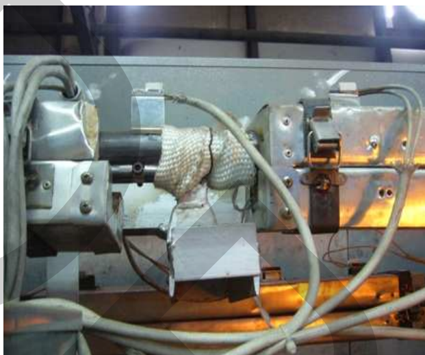
รูปที่ 5.3 เพิ่มฉนวนกันความร้อนช่วงรอยต่อ
