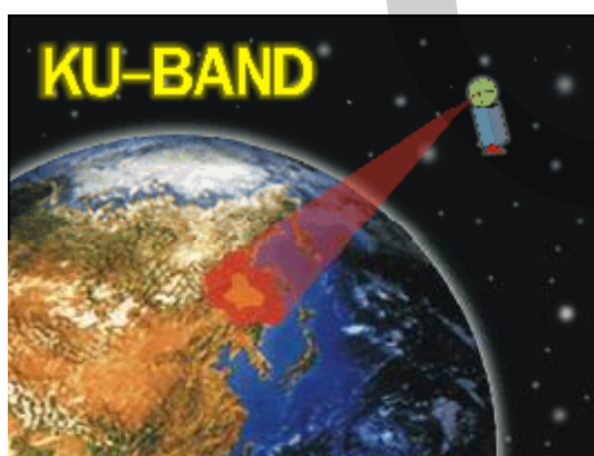
ภาพที่ 2.8 แสดงการส่งสัญญาณดาวเทียมระบบ KU-BAND พื้นที่แคบแต่ความเข้มสัญญาณสูงมาก ที่มา : www.engineering-mcot.net/mcotnorth
