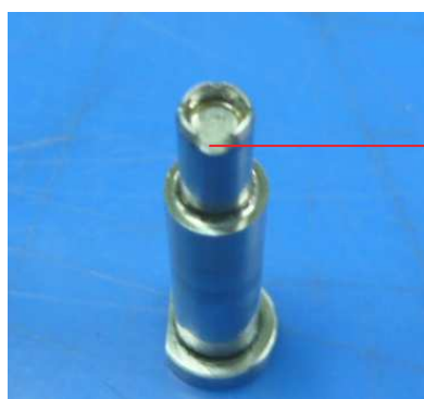
ภาพที่ 3.51 แสดง Punch แตกของเครื่อง Iron Core No.1 ค่าความแข็งไม่ได้ตามที่กำหนด
