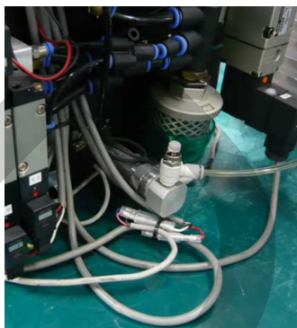
ภาพที่ 3.64 แสดงการจัดเก็บสายไฟไม่เป็นระเบียบของเครื่อง Resistor/Diode Insertion No.2
