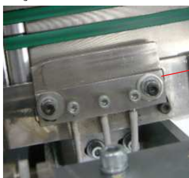
ภาพที่ 3.13 แสดงการติดตั้งฐานยึด Sensor
