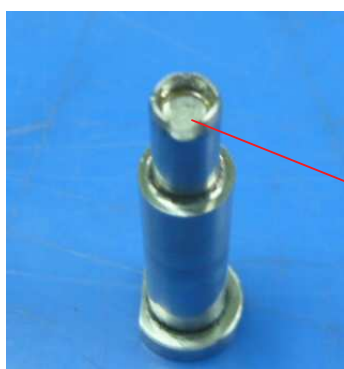
ภาพที่ 3.31 Punch สึกทำให้ค่าความแข็งไม่ได้
