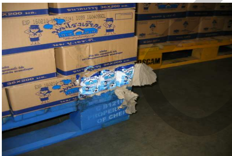
ภาพที่ 4.9 แสดง ความเสียหายที่เกิดจากรถยก
