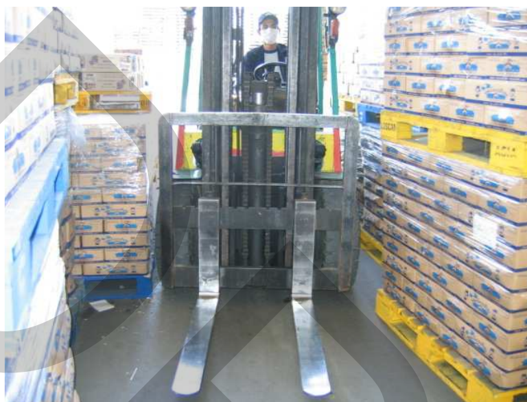
ภาพที่ 4.8 แสดง ช่องทางผ่านของรถยก กับช่องว่าง
