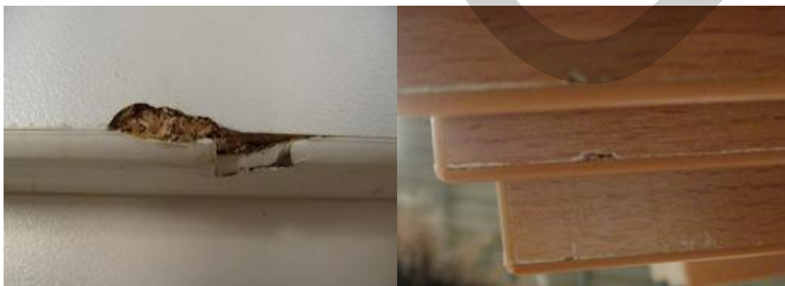
ภาพที่ 4.17 ชิ้นงานบกพร่องเครื่องกินขอบจากแรงดันลมตก
