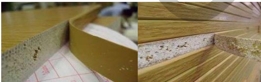
ภาพที่ 4.15 เอียงที่ไม้ได้เคลื่อน TYMER ทำให้กาวไม่ติด (ซ้าย) และเอียงที่เคลื่อน TYMER (ขวา)
