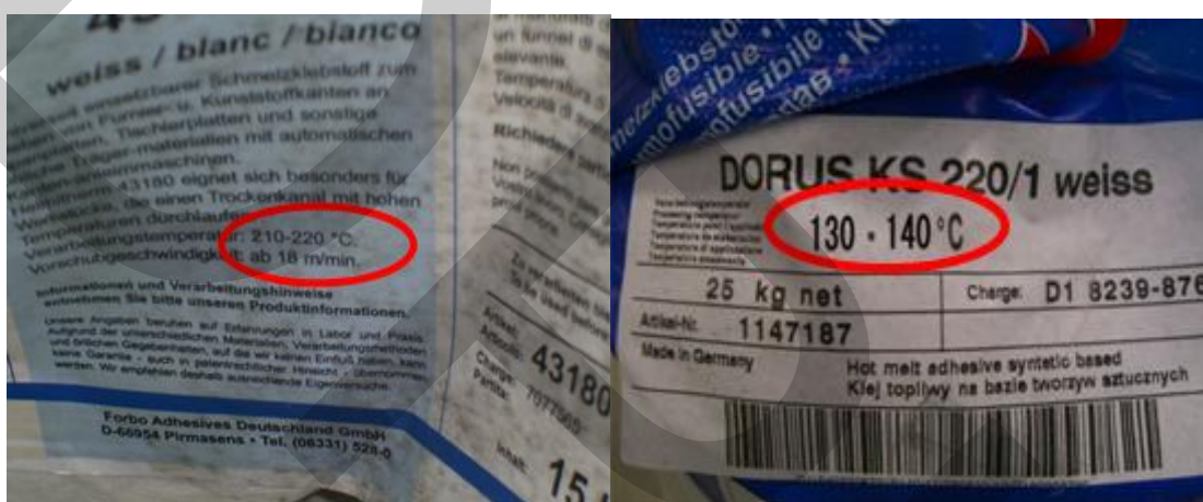
ภาพที่ 4.5 อุณหภูมิกาวก่อนแก้ไข 210-220 C (ซ้าย) และอุณหภูมิกาวหลังแก้ไข 130-140 C (ขวา)
