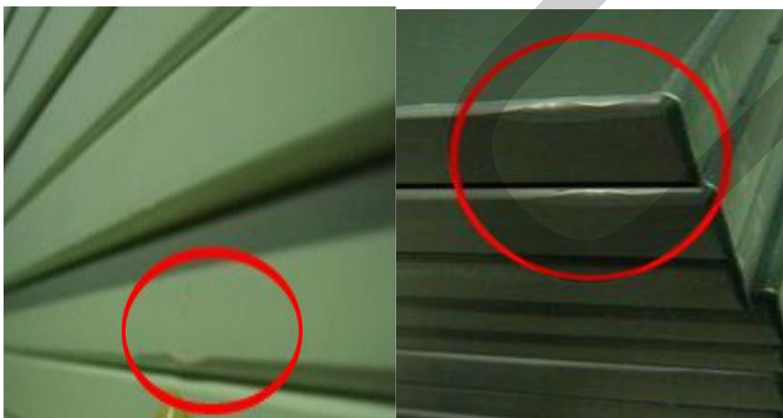
ภาพที่ 4.3 ขอบเป็นคลื่นไม่เรียบเสมอกันจากสาเหตุต่างๆ เช่น ไบมีดสีหรือ, ท่อไซโลไม่ดูแล
