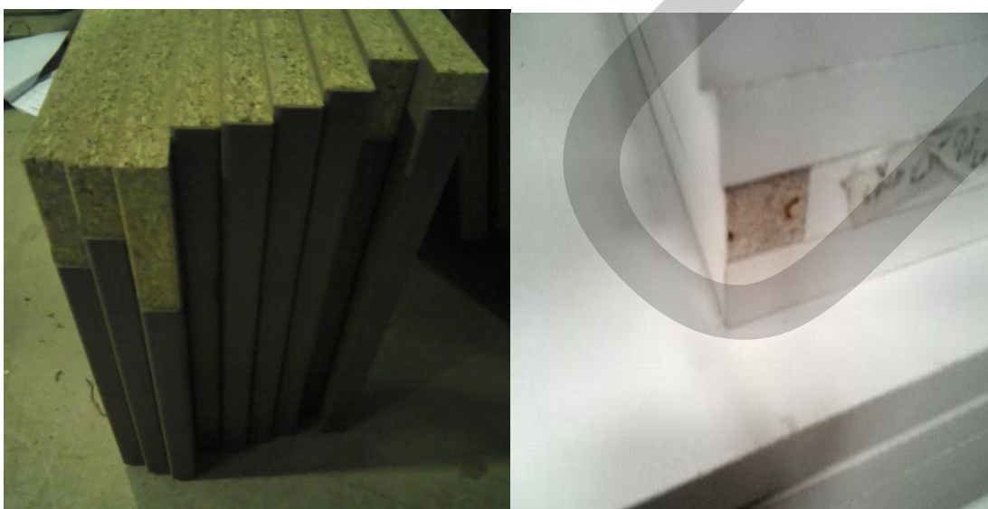
ภาพที่ 4.10 ตัวอย่างชิ้นงานที่มีข้อบกพร่องขอบไม่ติด
