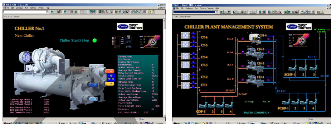
รูปที่ 3.41 ระบบควบคุมเครื่องทำน้ำเย็น (Carrier Comfort Network)
