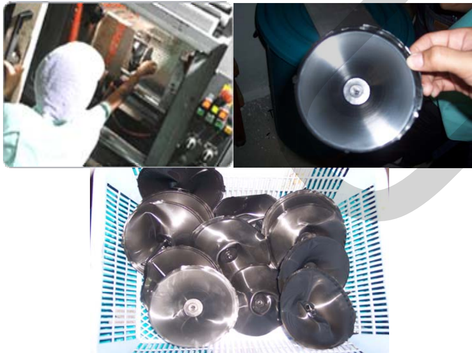
ภาพที่ 3.3 ภาพตัวอย่างลักษณะข้อบกพร่องของชิ้นงานจากระบวนการผลิตลำโพง
