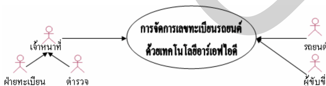
ภาพที่ 3.5 ภาพรวมของระบบจัดการเลขทะเบียนรถยนต์ด้วยเทคโนโลยีอาร์เอฟไอดีและผู้ที่เกี่ยวข้องต่าง ๆ ในระบบ
