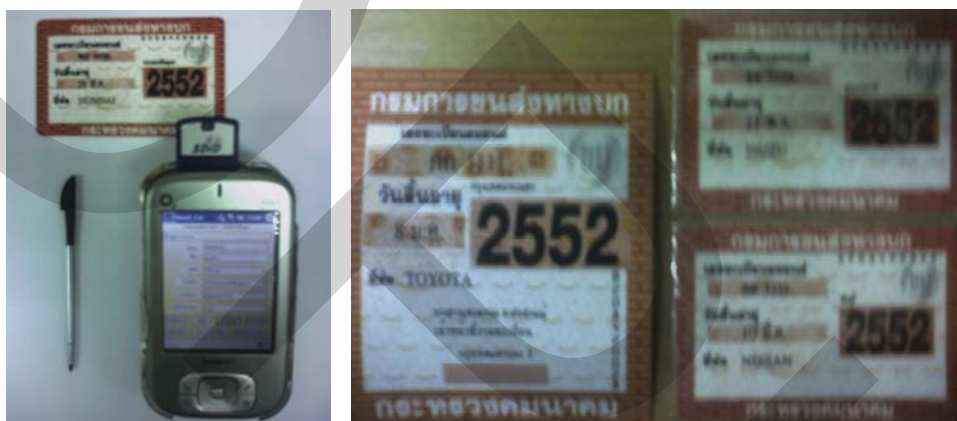
ภาพที่ 4.10 ภาพรวมการทำงานของระบบอาร์เอฟไอดีย่านความถี่สูง และการออกแบบป้ายภาษีอิเล็กทรอนิกส์สำหรับอาร์เอฟไอดีย่านความถี่สูง
