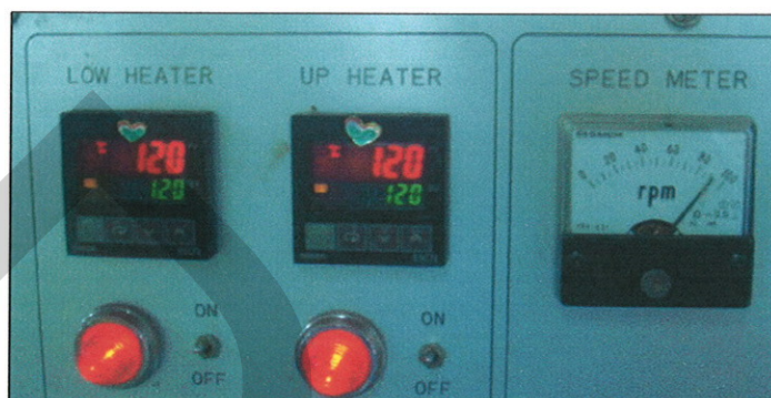
ภาพที่ 4.3 อุณหภูมิและความเร็วที่ใช้ในการขึ้นรูปเนื้ในปัจจุบัน
