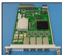
ภาพที่ 4.6 แสดงแผงวงจรอิเล็กทรอนิกส์รวมต้นแบบ (Know Good Board)
