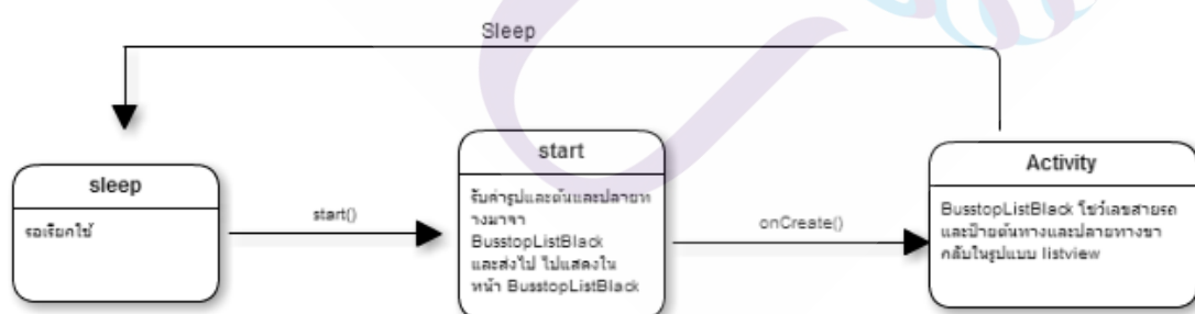
รูปที่ 3.27 state diagram ของ class CustomListAdapterbusstop_listB (Android User)
