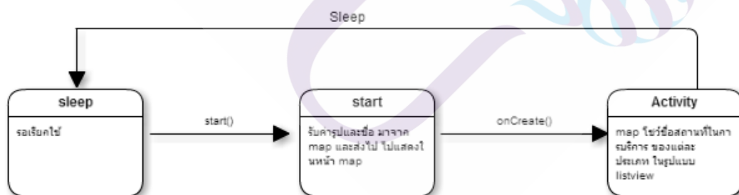
รูปที่ 3.33 state diagram ของ class CustomListAdaptermap (Android User)
