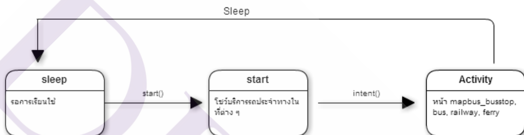
รูปที่ 3.32 state diagram ของ class map (Android User)
