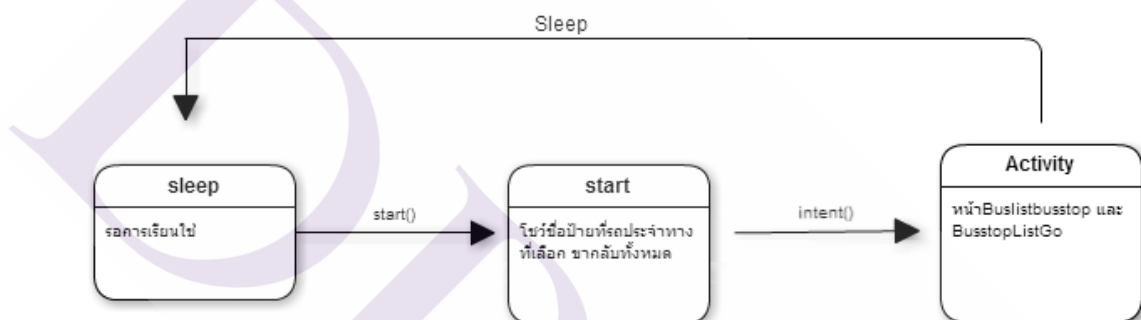
รูปที่ 3.26 state diagram ของ class BusstopListBlack (Android User)
