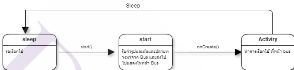
รูปที่ 3.21 state diagram ของ class bus (Android User)
