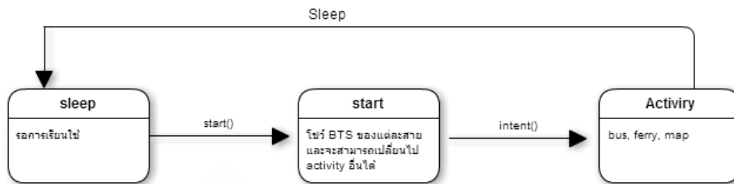
รูปที่ 3.28 state diagram ของ class railway (Android User)
