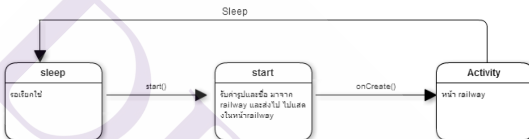
รูปที่ 3.29 state diagram ของ class CustomListAdapterrailway (Android User)
