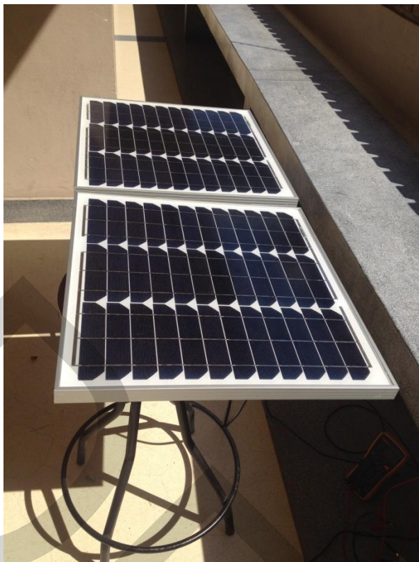
รูปที่ ก.3 แผงเซลล์แสงอาทิตย์ขนาดพิกัด 20W, 17.6V, 1.14A
