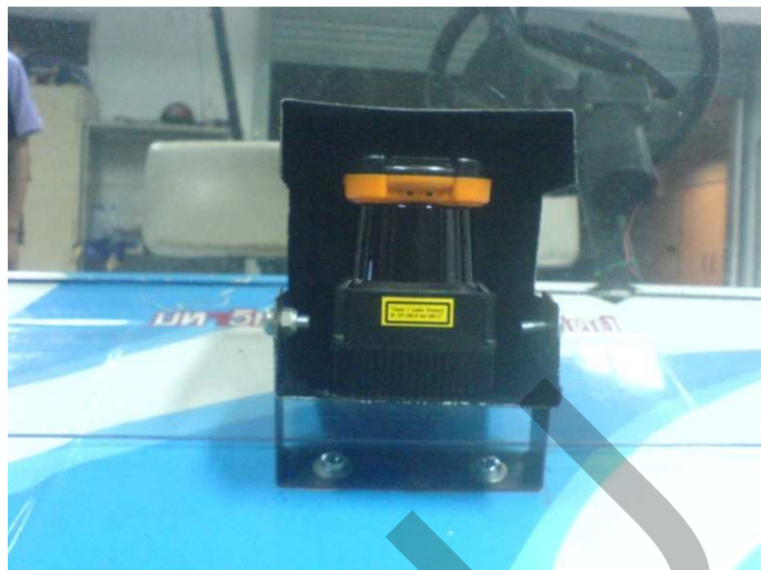
รูปที่ 4.8 ตำแหน่งของ Laser Range เมื่อติดตั้งกับตัวรถ
