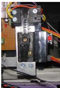
รูปที่ 3.19 ตำแหน่งการวางอุปกรณ์ Limit-switch เพื่อบังคับการเลี้ยว
