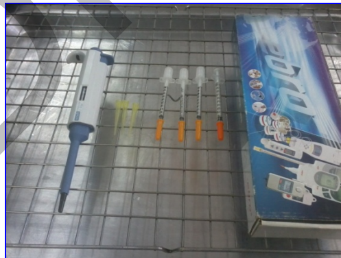
ภาพภาคผนวกที่ 8.2 micropipette syringe และ เทอร์โมมิเตอร์ดิจิทัลแบบปลายแหลม ที่ใช้ในการทดลอง
