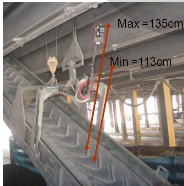
ภาพที่ 3.7 แสดงระยะความสูงของกล้องรับภาพจากรางสายพาน
