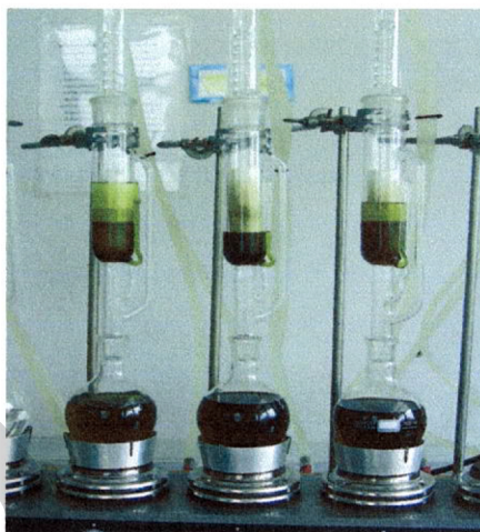
ภาพที่ 9 การสกัดแอนทราควิโนน (Anthraquinone) โดยใช้เครื่องสกัดชอกซ์เลต
