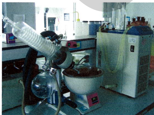
ภาพที่ 11 ระเหยตัวทำละลายด้วยเครื่องระเหยสุญญากาศแบบหมุน
