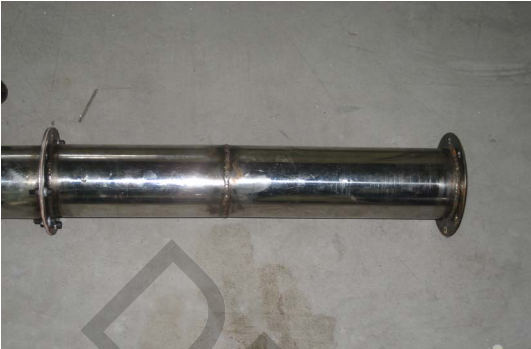
ภาพที่ ค.9 การนำหน้าแปลนมาเชื่อมกับท่อเสตนเลสตรง
