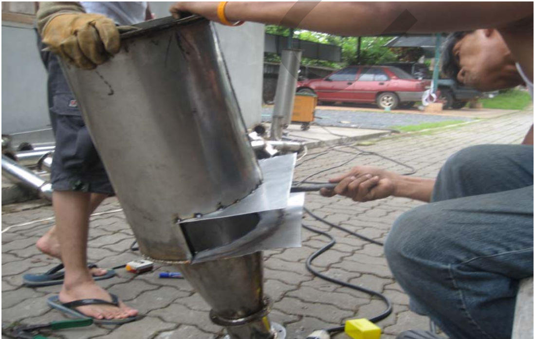
ภาพที่ ค.14 การทำห้องอบแห้งแบบชั้นบาง
