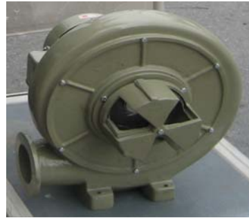
ภาพที่ น.2 พัดลม (blower) แบบใบพัด ใ้คงหลัง
