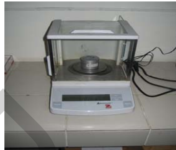
ภาพที่ น.4 เครื่องชั่ง ซึ่งสามารถชั่งได้สูงสุด 600 g
