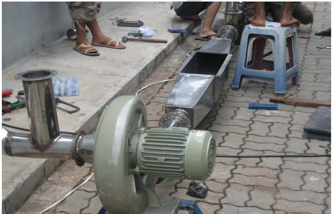
ภาพที่ ค.18 การประกอบ Blower เข้ากับกล่อง Heater
