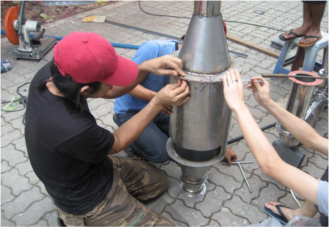
ภาพที่ ค.13 การทำห้องอบแห้งแบบชั้นบาง
