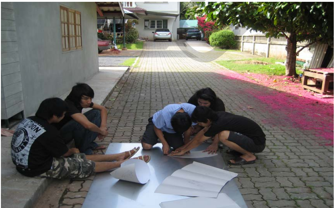
ภาพที่ ค.2 การนำแบบกระดาษมาวางลงแผ่นสแตนเลส
