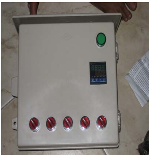
ภาพที่ ค.24 ชุดตัวควบคุมไฟฟ้าของเครื่องอบแห้ง
