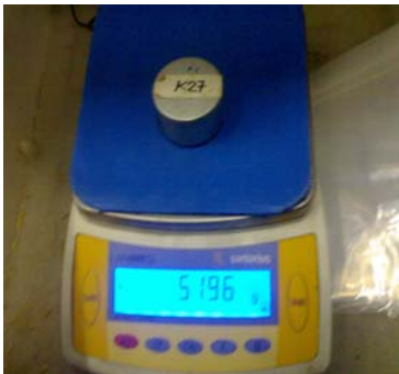
ภาพที่ น.5 เครื่องชั่ง ซึ่งสามารถชั่งได้สูงสุด 2,100 g
