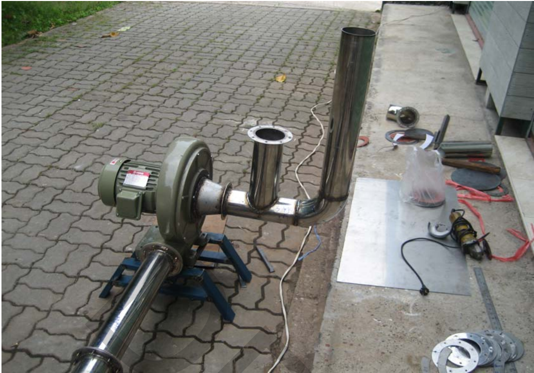
ภาพที่ ค.17 การประกอบ Blower เข้ากับท่อดูดอากาศเข้า
