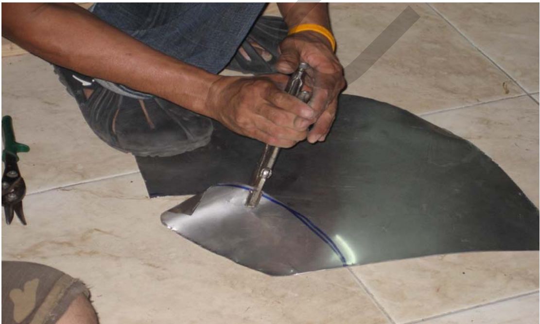
ภาพที่ ค.4 การตัดสแตนรูปกรวยของห้องอบแห้ง
