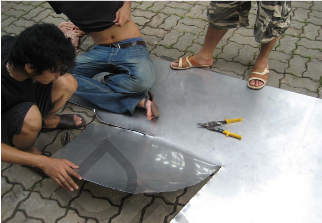
ภาพที่ ค.3 การตัดสแตนของกล่อง Heater
