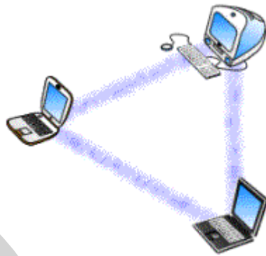
รูปที่ 3.5 แสดงการทำงานในโหมด Ad-hoc หรือ Peer-to-Peer Mode [11]
